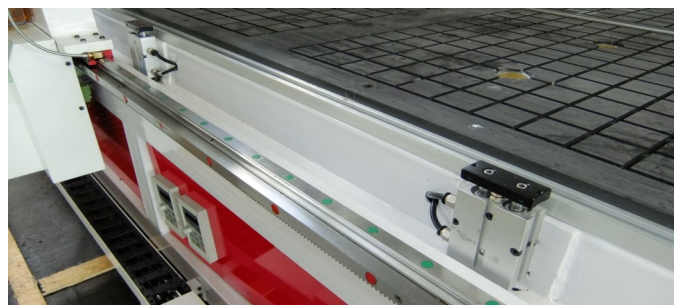
Bild 7. Pneumatische Anschläge ffür X und Y Achse
