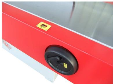
Großdimensioniertes Handrad zum Einstellen der Spanabnahme
